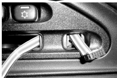
Рис. 2. Порядок укладки шлейфа.
