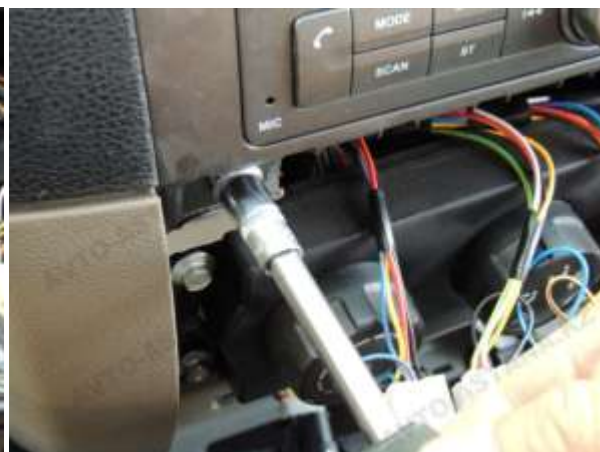
Фото 4.1. Болты крепления панели
