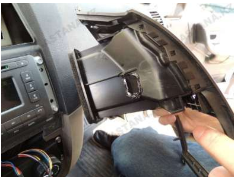
Фото 8. Отверстие в воздуховоде.
