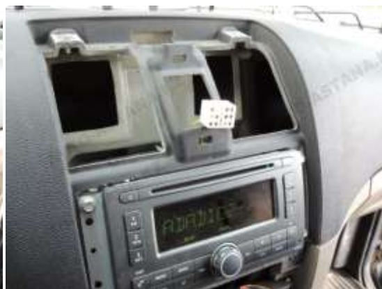
Фото 5.1 Снятая верхняя часть панели.
