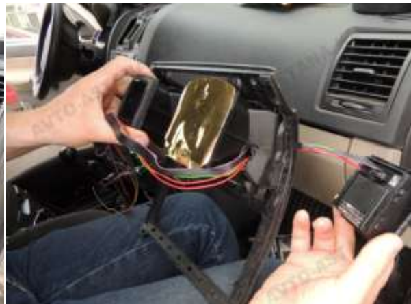
Фото 13.1. Шлейф продет через отверстие.
