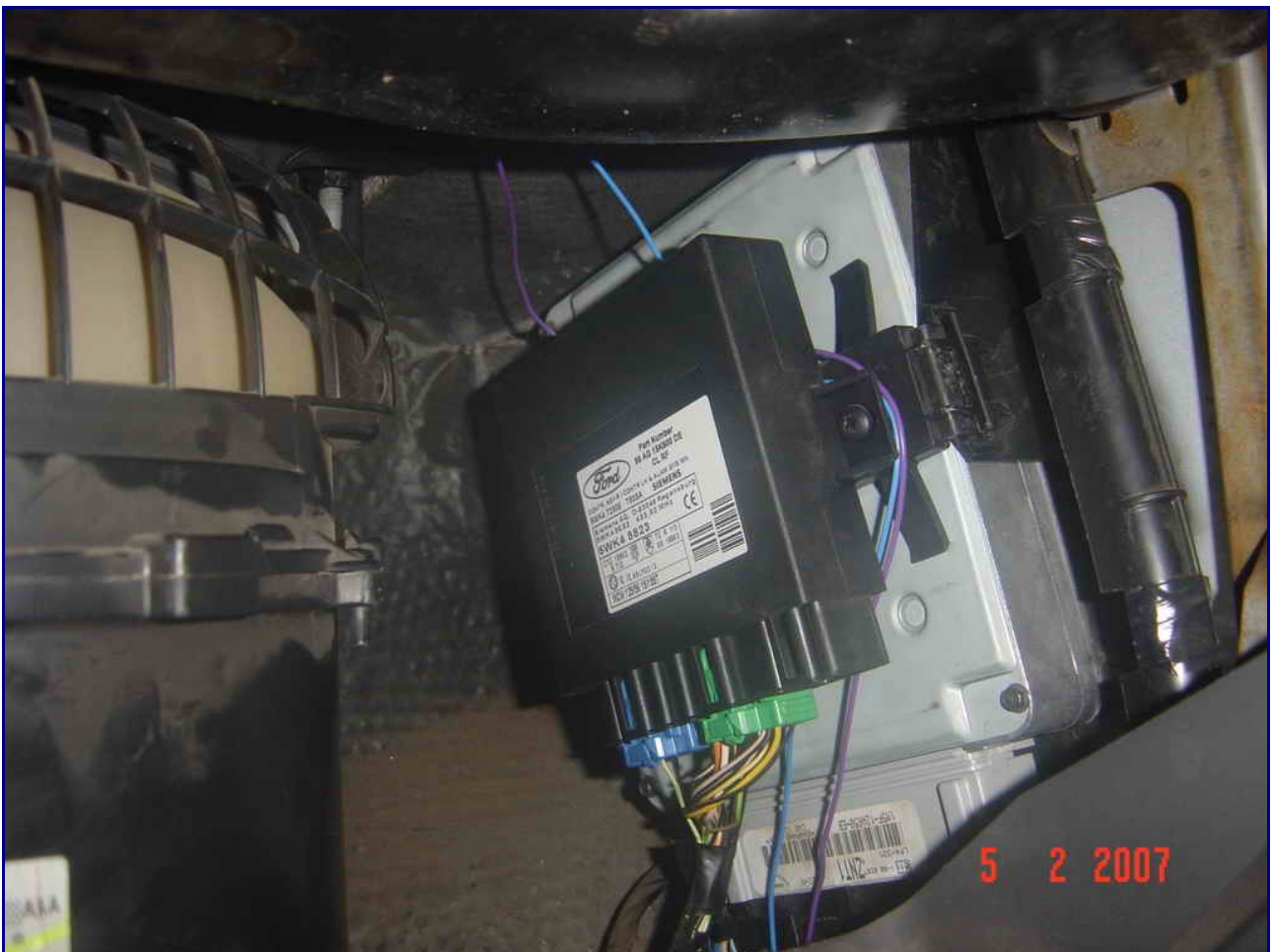
Укладываем провода и ставим ЭБУ на место
